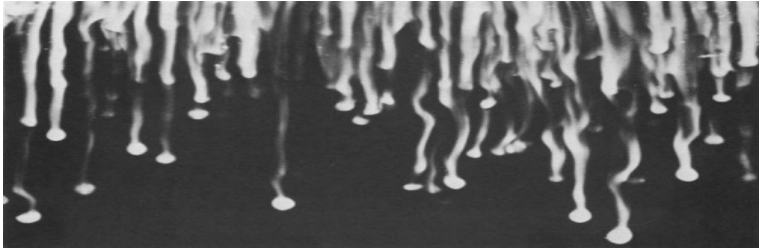
Рис. 1. Ансамбль термиков в форме тяжелых солевых пальцев, опускающихся в водяном слое, согласно [4].
